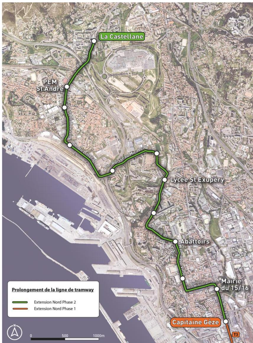
Figure 1 : tracé de l'extension Nord du tramway T3 – Phase 2 (source MAMP)
